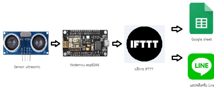
รูปที่ 2 หลักการทำงานของกล่องรับพัสดุอัจฉริยะ (Creating a Smart Parcel DeliveryBox)
