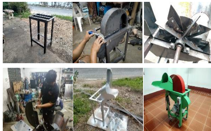
รูปที่ 2 การสร้างเครื่องหั่นพืชขอเนกประสงค์
