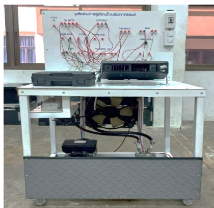
รูปที่ 1 ชุดฝึกทักษะระบบปรับอากาศยานยนต์
